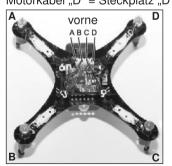
**ACHTUNG:** Stellen Sie sicher, dass die Motorkabel nach einer Reparatur korrekt angeschlossen sind.
