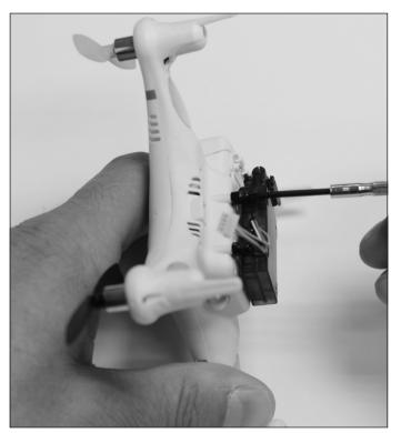
Befestigen Sie die Kameraeinheit mit den vier beiliegenden Schrauben unten am Gehäuse. Achten Sie dabei darauf, dass das Objektiv der Kamera nach vorne zeigt.
